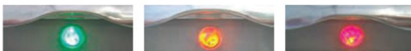
・正常(点灯) ・警告(点滅) ・点滅(電源電圧異常) ・点灯(出力停止)
